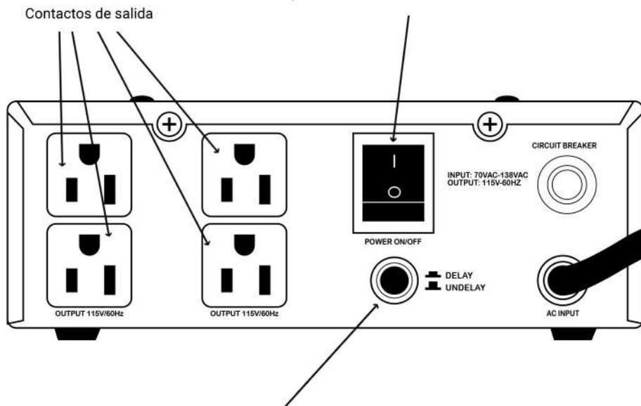
Si este regulador se utiliza para un aparato con compresor de motor integrado, seleccione "DELAY (RETARDO)", para disminuir la oportunidad de dañar el compresor de motor. Si no, por favor seleccione "UNDELAY".
